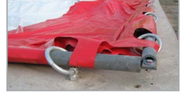
Metal boru üzerine yüzük ankraj geçirme
